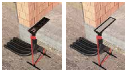
Die BOX enthält das vormontierte Installationsset
