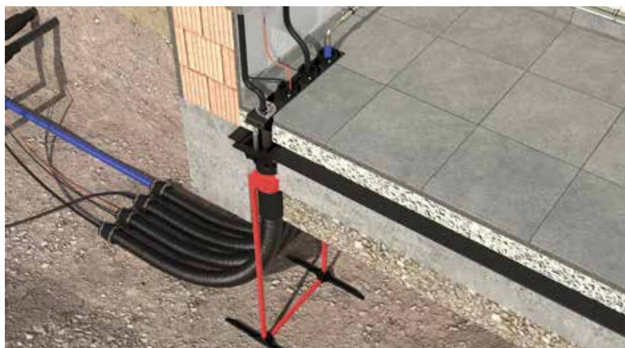
Durch das vormontierte Installationsset entfällt die Gewerke-übergreifende Übergabe
