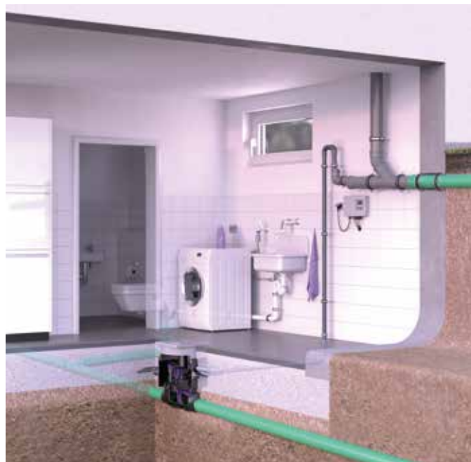
Einbaudarstellung Ecolift in einem Kellerbad
